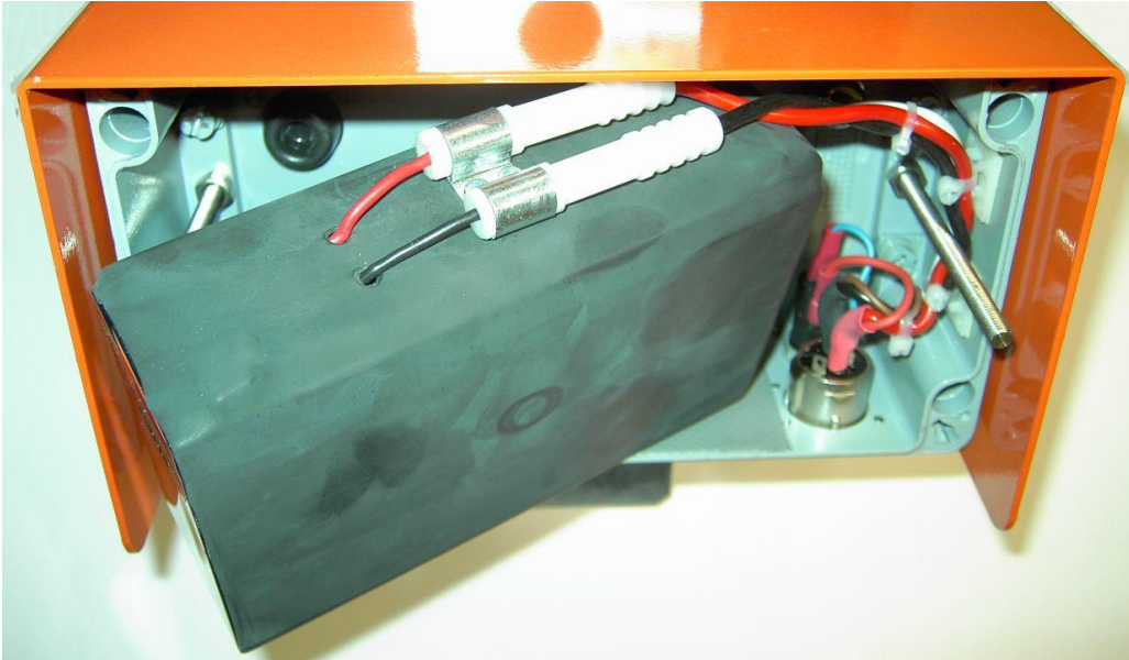
Abbildung 7.1: Akkumulator bei geöffnetem Batteriegehäuse
